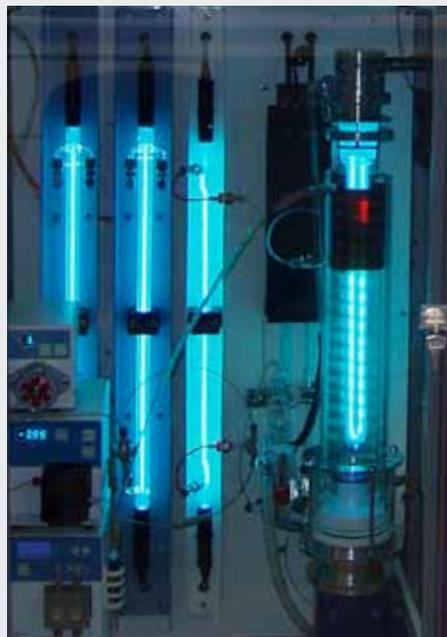
Sistema de ensayo de oxidación avanzada
