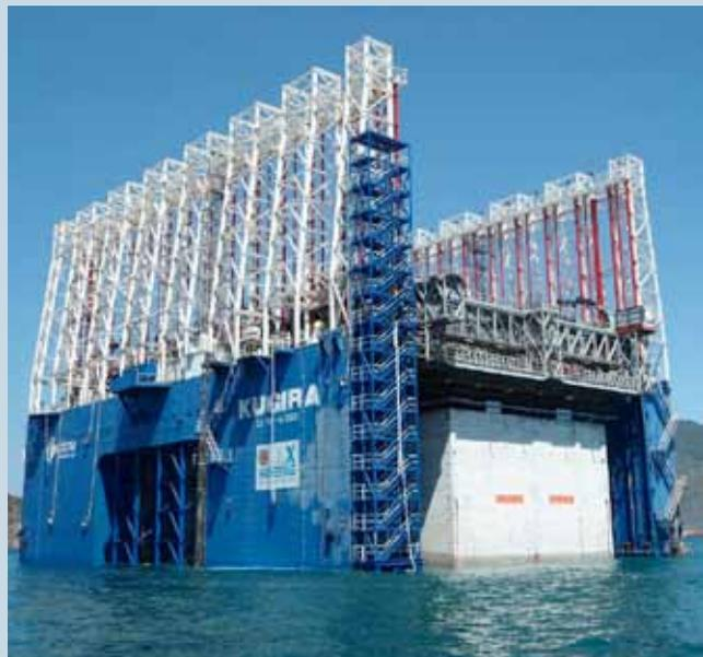
*El dique flotante Kugira (derecha) fabricará los cajones que se utilizarán en la construcción del astillero de Açú.*
